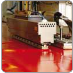
HF Schweißarbeiten high frequency application
